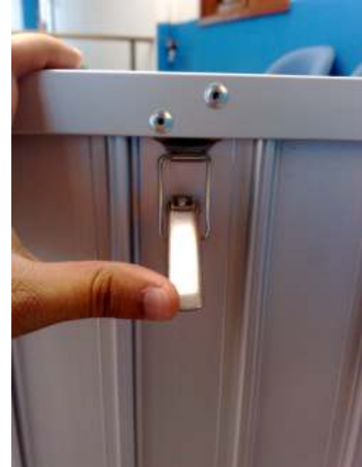
5. Coloque el sujetador sobre el gancho y presione para asegurar
